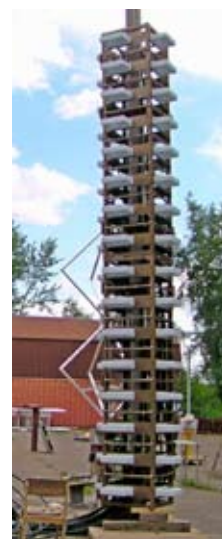
Рис. 4. Панельная антенна IV-V диапазонов из 16 этажей вибраторов
