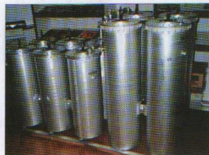
Фото 2 4-канальный мультиплексор для УКВ ЧМ и FM-вещания
