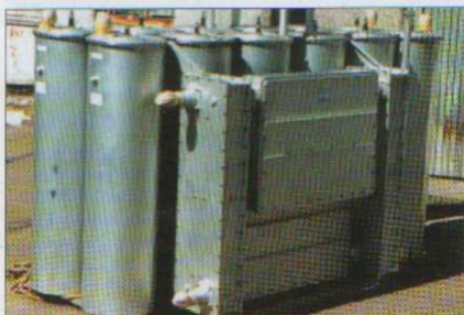
Фото 1 Смешанное УС 4 каналов УКВ ЧМ и 3-го телевизионного канала
