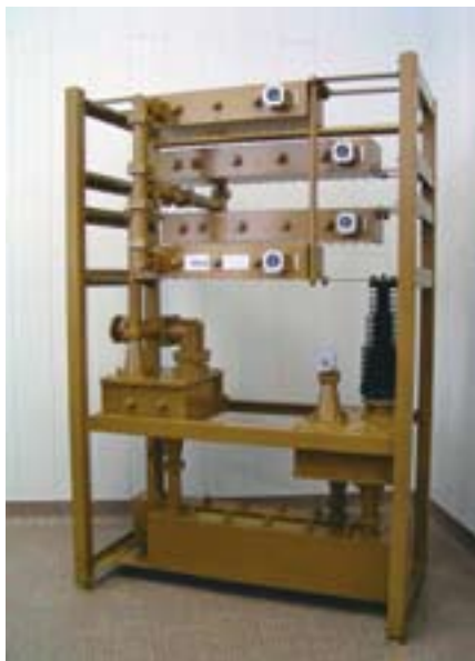
Устройство сложения пяти сигналов ДМВ-диапазона (по 1 кВт в канале)
